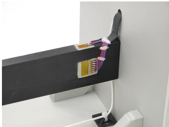
Bild 4. Messstellen mit Lötstützpunkten und Zugentlastungen
